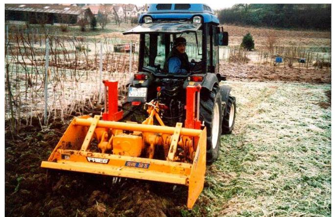
Der leicht aufklappbare Schutzkorb ermöglicht eine einfache Wartungs- und Reinigungsarbeit an der WFS-Spatenmaschine. An diesem Bild kann man die Baukasten-Bauweise erkennen. Sämtliche Einzelteile sind verschraubt und nicht verschweißt.
